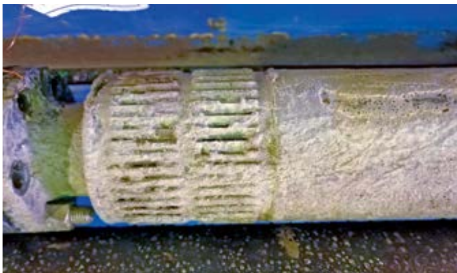
Рис. 1. Солеотложение на входном модуле нефтепогружного оборудования
