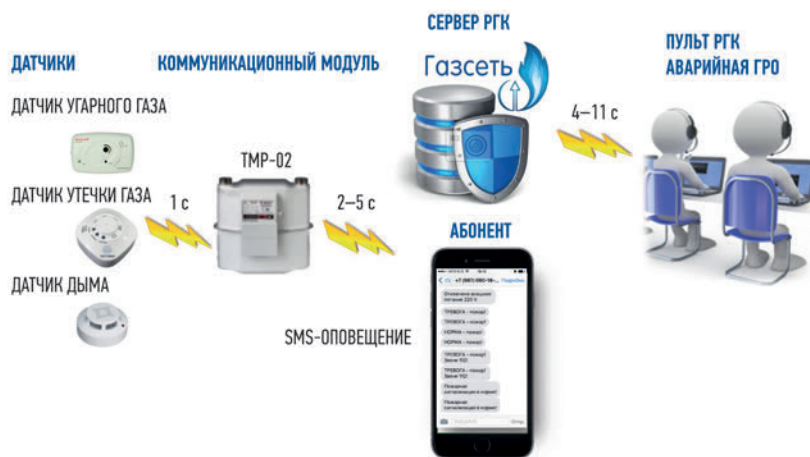
Рис. 3. Схема оповещения РГК, ГРО и абонента о нештатной ситуации на УУГ
