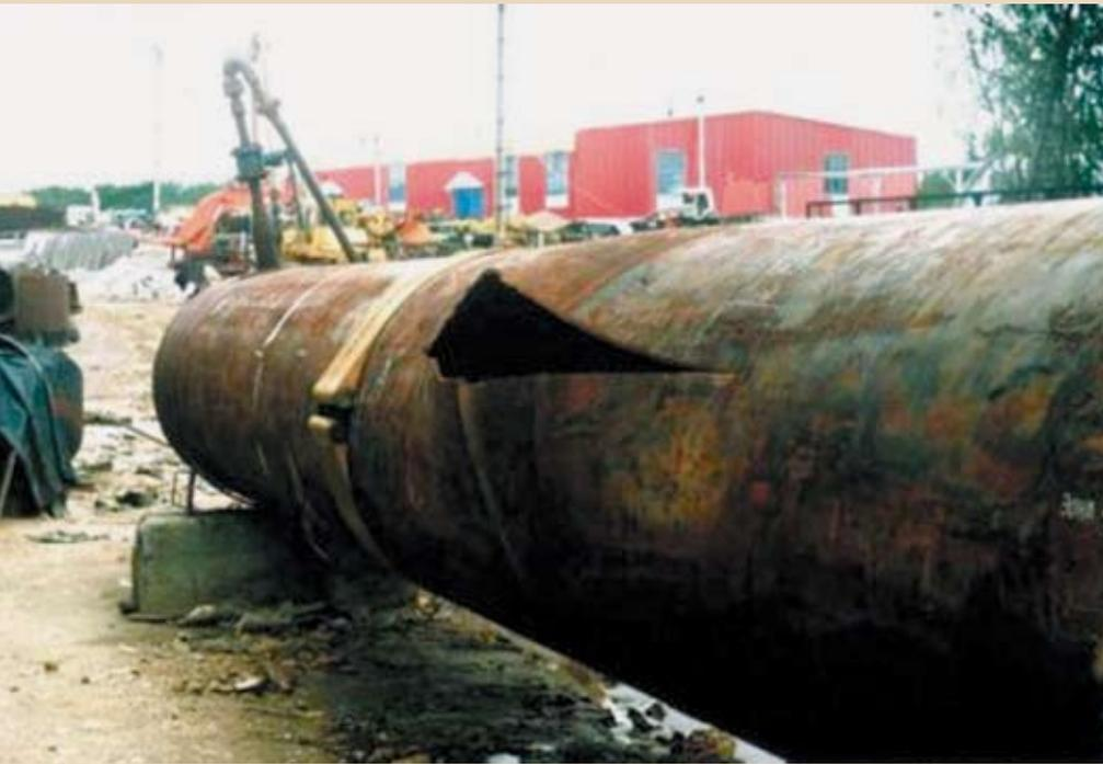
**Рисунок 4. Разрушенная труба на полигонных испытаниях муфты РСМ–1220**
