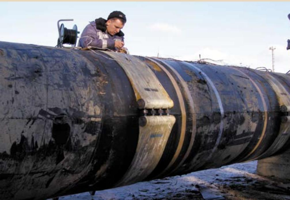
**Рисунок 6. Испытания трубы диаметром 1420 мм с муфтами РСМ–1420**
