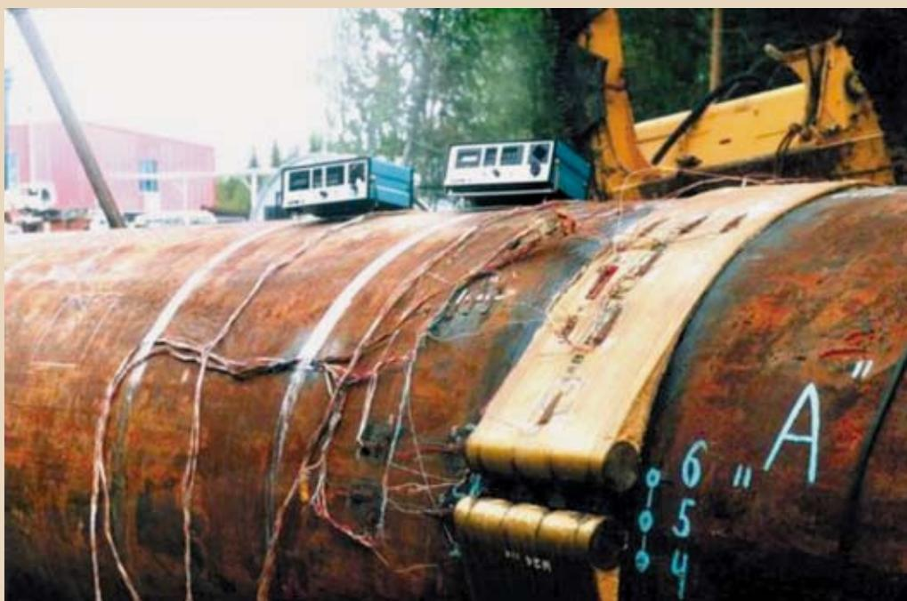
**Рисунок 3. Оснащение трубы и муфты РСМ–1220 средствами измерений — тензодатчиками**
