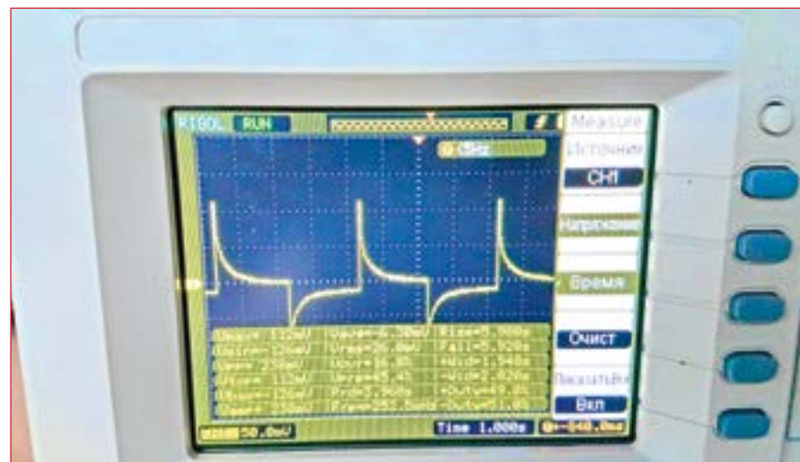
Рис. 8. Форма сигнала защитного тока от устройства знакопеременной поляризации УЗП-С на образцах гравиметрических лабораторных испытаний
