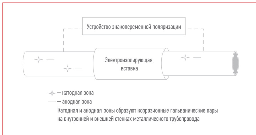
Рис. 2. Принцип организации противокоррозионной защиты наложением переменного тока
