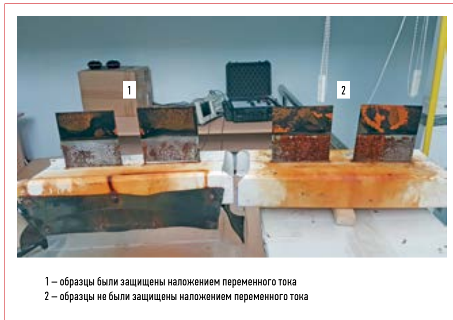
Рис. 6. Внешний вид образцов после выдержки в течение 10 сут в растворе NaCl (3 масс. %) при температуре 20 °С
