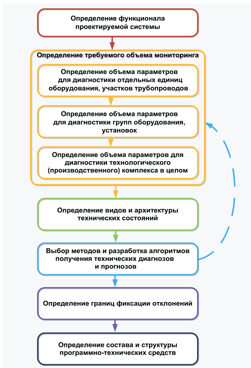
Рис. 1. Блок-схема последовательного решения задач построения систем мониторинга и диагностики ТС оборудования и средств автоматизации
