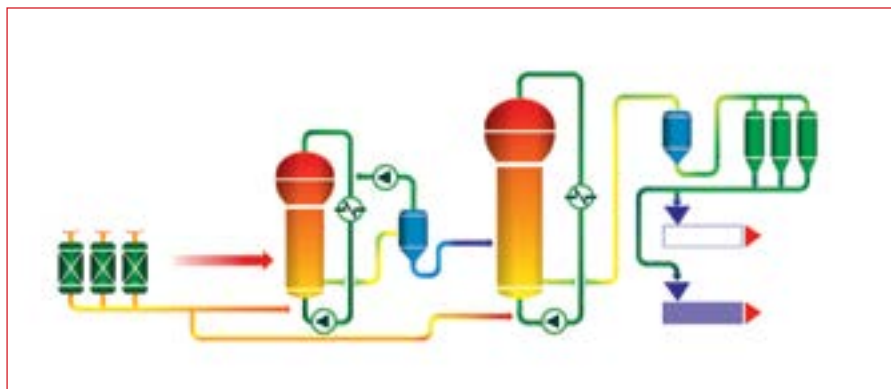
Рис. 3. Принципиальная схема получения полиэтилена по технологии Spherilene
