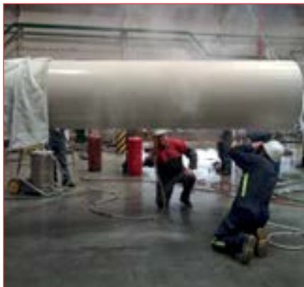
Рис. 1. Нанесение эпоксидного слоя покрытия на «материнскую» трубу, из которой были изготовлены отводы для тестов на катодное отслаивание
