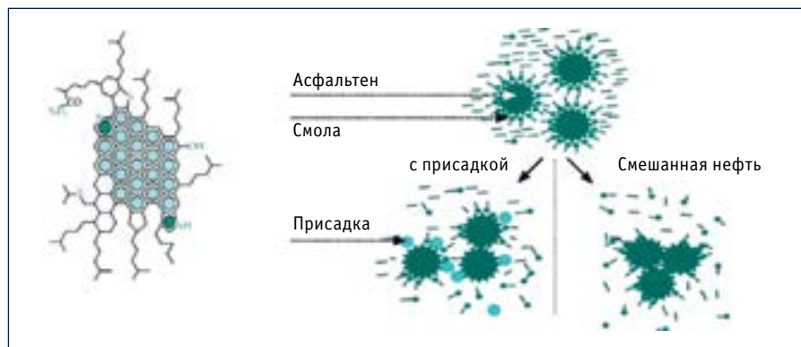
Рис. 1. Принцип действия ингибиторов асфальтена серии ASI
