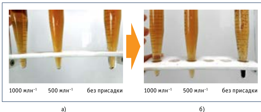
Рис. 2. Результаты наблюдения за седиментацией асфальтенов: а) через 20 мин; б) через 2 ч
