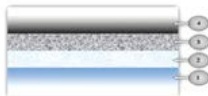
Рис. Схема структуры защитного слоя асмора на поверхности стали: 1 – металл; 2 – промежуточный слой металла с измененной структурой; 3 – поверхностный слой продуктов взаимодействия сульфокислот асмора со ржавчиной; 4 – объемный слой асморного материала
