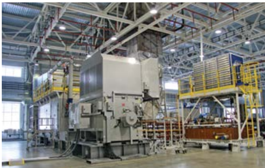
Фото 2. Испытания газотурбинной установки GTA-16 на стенде «ОДК – Газовые турбины»
