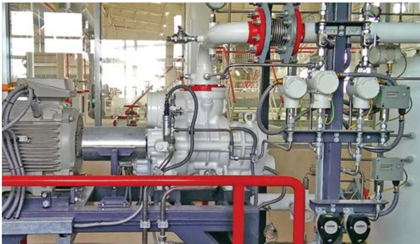
Фото 8. Компрессорная установка-симулятор для Учебного центра ОАО «Сургутнефтегаз»
