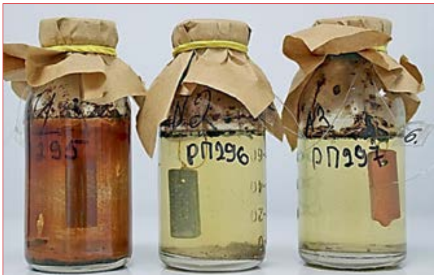
Рис. 4. Вид испытательных емкостей в момент перед извлечением образцов (время выдержки – 95 сут): емкость № 1 – образец без покрытия; емкость № 2 – образец с ТДЦ; емкость № 3 – образец с majorpack MPAG96
