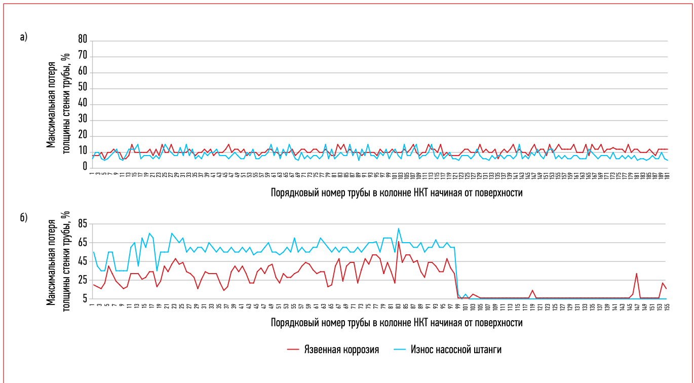
Рис. 5. Результаты вихретоковой дефектоскопии подвески:
