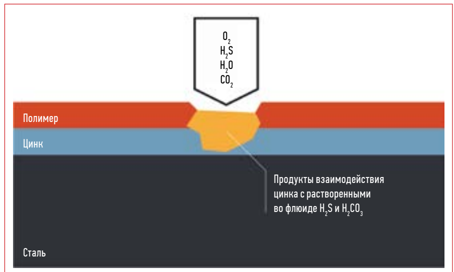
Рис. 3. Механизм замедления развития коррозии в присутствии дуплексной системы majorpasc MPAG
