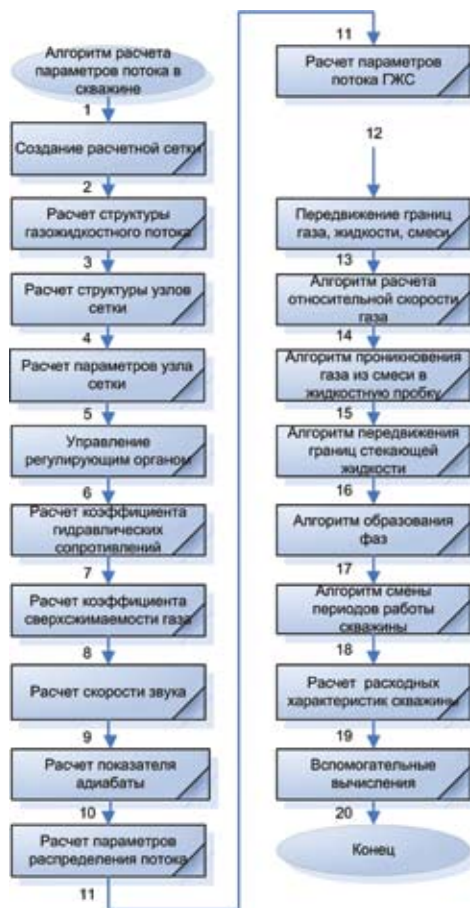
Рис. 1. Блок-схема алгоритма расчета параметров движения потока в скважине
