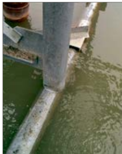
Рис. 4. Заколонное газопроявление (грифон) на эксплуатационной газовой скв. 9162 ЯНГКМ (фото авторов)
