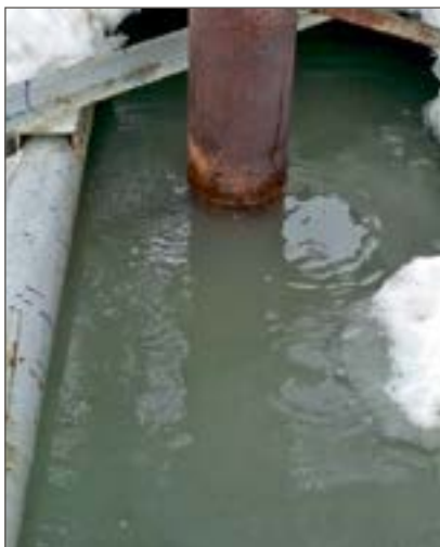
Рис. 2. Заколонные газопроявления (грифоны) на эксплуатационных газовых скв. 9032, 9052 ЯНГКМ (фото авторов)
