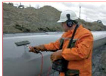
Рис. 14, 15. Контроль толщины и диэлектрической сплошности изоляции газопровода
