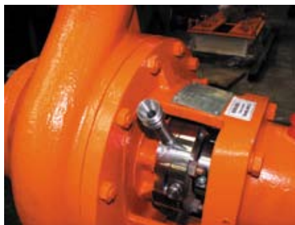
Рис. 4. Пример некорректного расположения штуцеров относительно крепежных деталей
