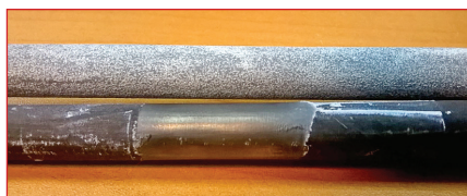
Рис. 7. Внешний вид поверхности анодов с оксидным покрытием и без покрытия после окончания эксперимента
