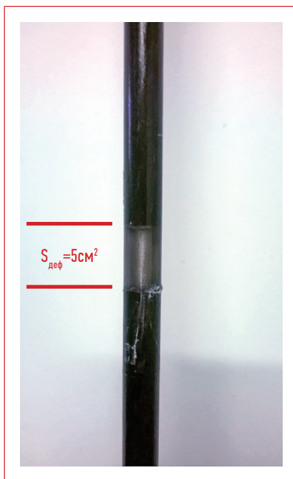
Рис. 4. Поверхность ТЭМС ТП (АЗК-ОП) после эксперимента. Участок с искусственным дефектом площадью 5 см 2
