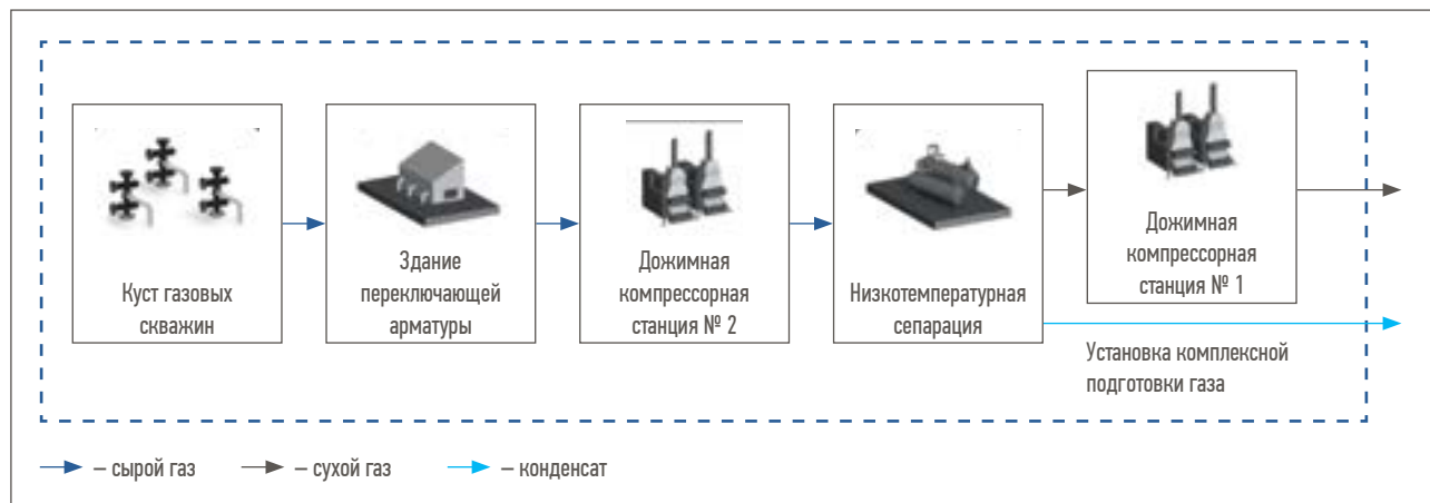
Рис. 4. Укрупненная технологическая схема газового промысла Бованенковского НГКМ
