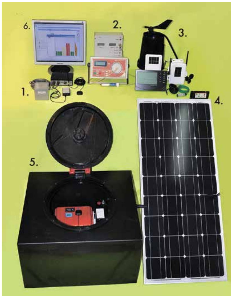
Фото 4. Комплекс технических средств автоматизированной системы раннего оповещения опасных геологических процессов (АСК-ГП):
