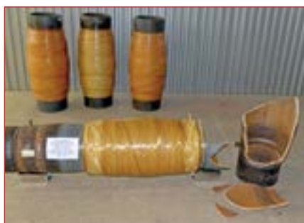
Гидравлические испытания ВЭИ DN 300-22 PN 25 МПа. Разрушающее давление при сохранении целостности силовой муфты – 76 МПа
