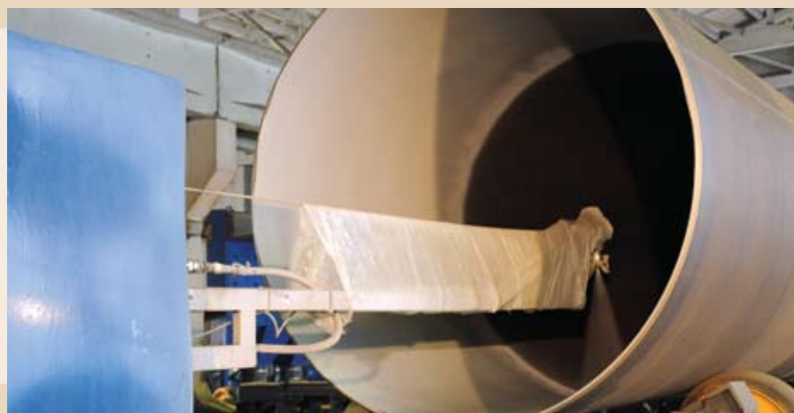
Рис. 5. Нанесение покрытия Amercoat
