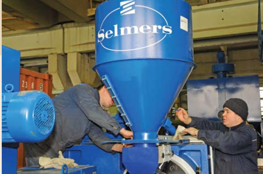
Рис. 2-3. Пуск и наладка оборудования по нанесению двух- и трехслойной изоляции
