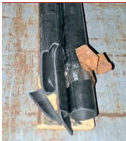
Рис. 2. Разрушение анодного заземлителя при транспортировке
