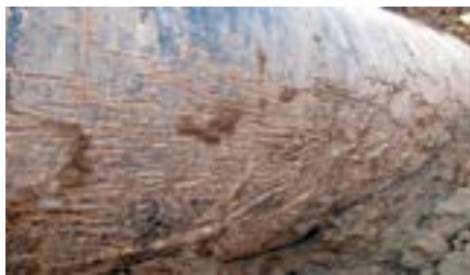
Рис. 3. Вид изоляции «Транскор-газ» через 8 мес после нанесения при температуре -12\text{ }^{\circ}\text{C} Fig. 3. Type of insulation “Transcor-gas” 8 months after application at a temperature of -12\text{ }^{\circ}\text{C}
