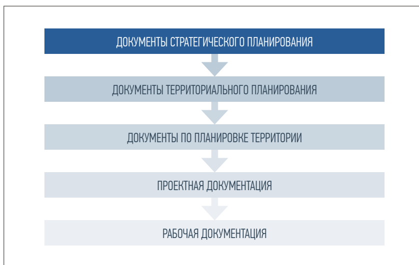
Рис. 3. Система плановых и проектных документов для строительства
