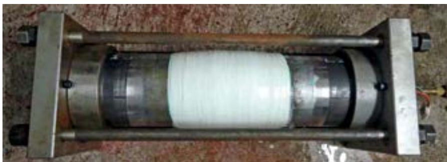
Рис. 1. Труба № 1 после проведения испытаний. При повреждении жидкость начала капать в месте нанесения ремонтного материала
