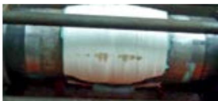
Рис. 2. Труба № 2 после проведения испытаний. При повреждении произошел разрыв трубы и ремонтного материала
