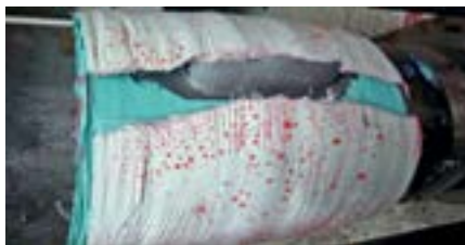
Рис. 3. Труба № 3 после проведения испытаний. При повреждении произошел разрыв трубы и ремонтного материала
