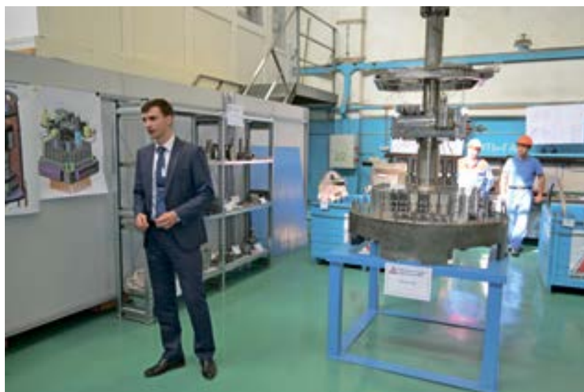
Подводный модуль управления на стадии сборки
