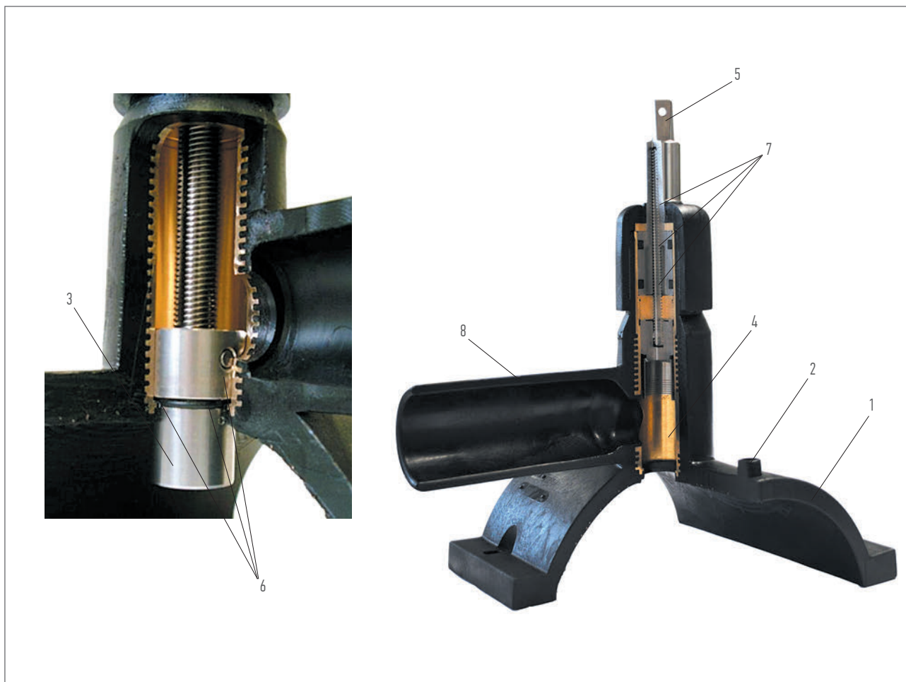
Рис. 2. Конструкция вентиля для врезки под давлением Frialen тип DAV: 1 – корпус из полиэтилена РЕ100; 2 – два контакта для сварки; 3 – интегрированная фреза с верхним и нижним упором; 4 – металлическая гильза для хода фрезы; 5 – вращающийся шпindel на 14 мм из легированной стали 1.4305 для перекрытия рабочей среды; 6 – трехкратное внутреннее уплотнение в нижнем положении (ПЭ-металл, O-кольцо, металл – металл); 7 – трехкратное внешнее уплотнение (O-кольцо); 8 – выходной патрубок, рассчитанный на две сварки
