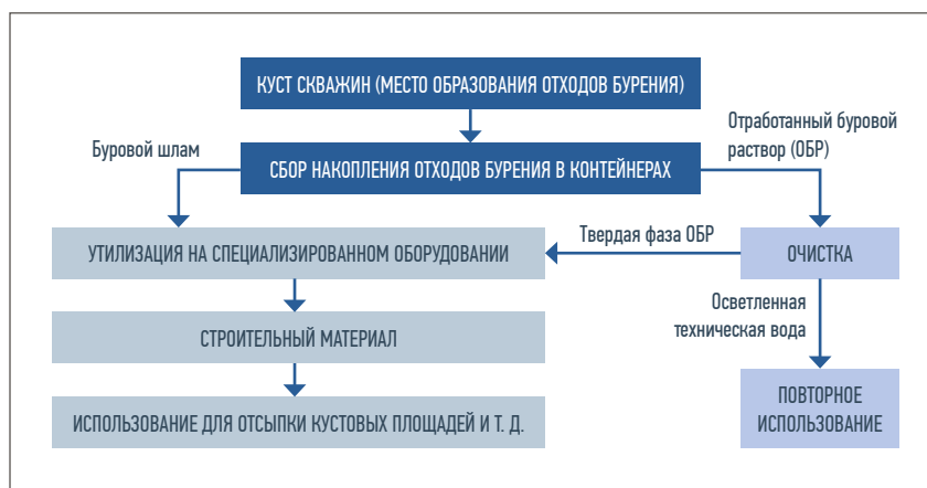
Рис. 1. Схема накопления и утилизации отходов при безамбарном строительстве скважин
