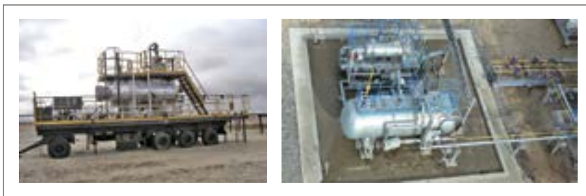
Рис. 2. Исследовательские сепараторы, работающие без выпуска газа в атмосферу
