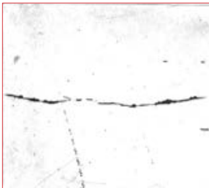
Рис. 2. Строчки вытянутых вдоль оси трубы (в направлении деформации) неметаллических включений (при 500-кратном увеличении)
