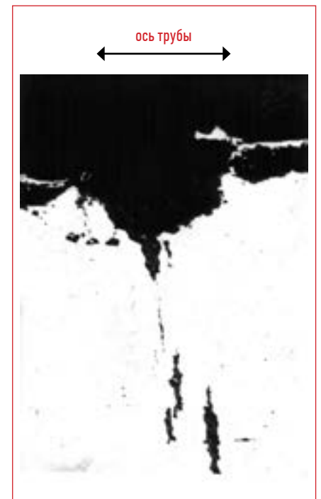
Рис. 4. Продольный шлиф (нетравленный образец). Коррозионные язвы и трещины в подповерхностном слое внутренней стенки трубы. Поперечное по отношению к направлению деформации трубы расположение трещин
