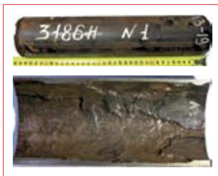
Рис. 1. Углекислотная коррозия НКТ (Нонг-Еганское месторождение, скв. 3186Н, к.п. № 45)
