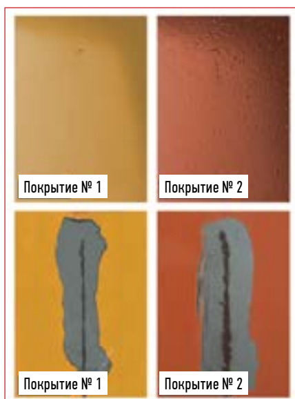
Рис. 1. Результаты испытаний на коррозионную стойкость. Вверху – результаты испытаний в гидростате после выдержки в течение 10 сут. Внизу – результаты испытаний в камере соляного тумана после выдержки в течение 20 сут
