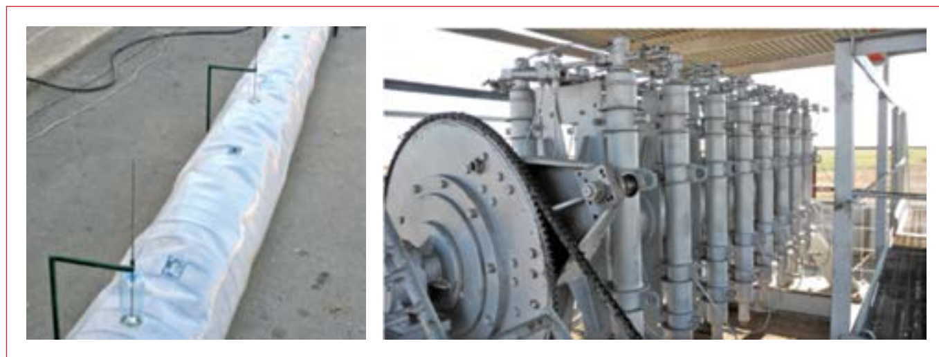
Рис. 4. Модель трубопровода для отработки технологии ингибирования (а), стенд для коррозионных испытаний материалов и испытаний ингибиторов СПКИ-16-5 (б)
