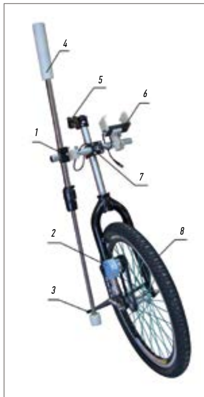
Рис. 2. Внешний вид приборного комплекса для БМД: 1 – универсальная головка; 2 – узел счета длины; 3 – складная опорная стойка; 4 – датчик Тип 11; 5 – ручка; 6 – узел крепления измерительного прибора ИКН; 7 – узел крепления датчика Тип 11; 8 – дорожное колесо
