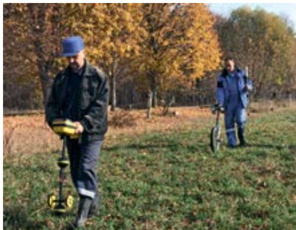
Рис. 3. Запись магнитограмм над осью трубопровода при наземном обследовании
