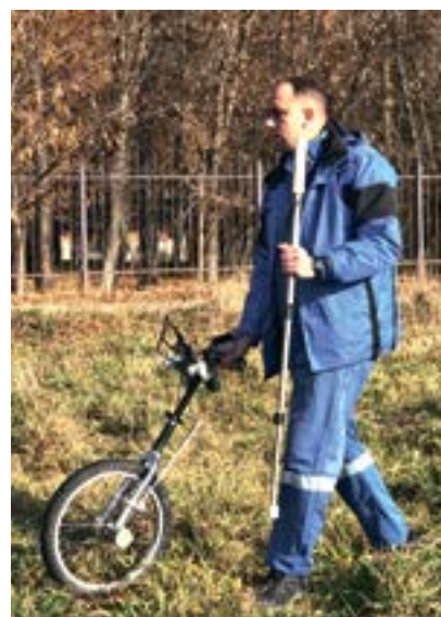
Рис. 1. Проведение БМД с использованием приборного комплекса по методу магнитной памяти металла
