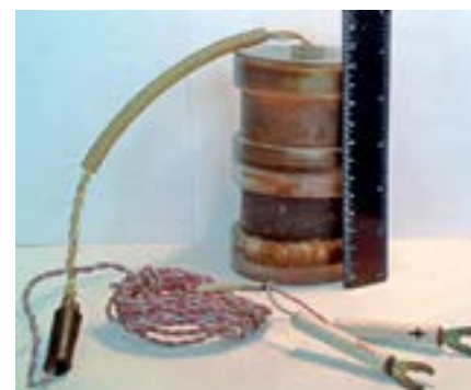
Рис. 4. Датчик скорости коррозии после проведения испытаний в полевых условиях Fig. 4. A corrosion rate sensor after the field tests
