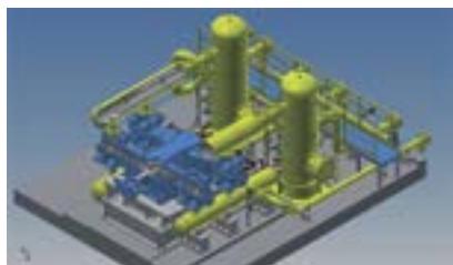
Рис. 7. Макет локализованной ИНГК ПКУ для станций подземного хранения газа на базе поршневого компрессора Borsig ZM и привода отечественного производства
