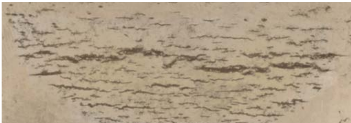
Рис. 11. Стресс-коррозионные трещины, полученные в лабораторных условиях на стали X-46
