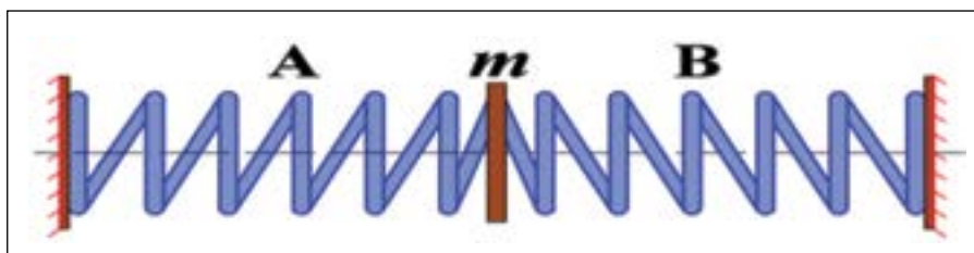
Рис. 2. Модель влияния запаса упругой энергии сжатого газа на развитие повреждений в стенке газопровода
