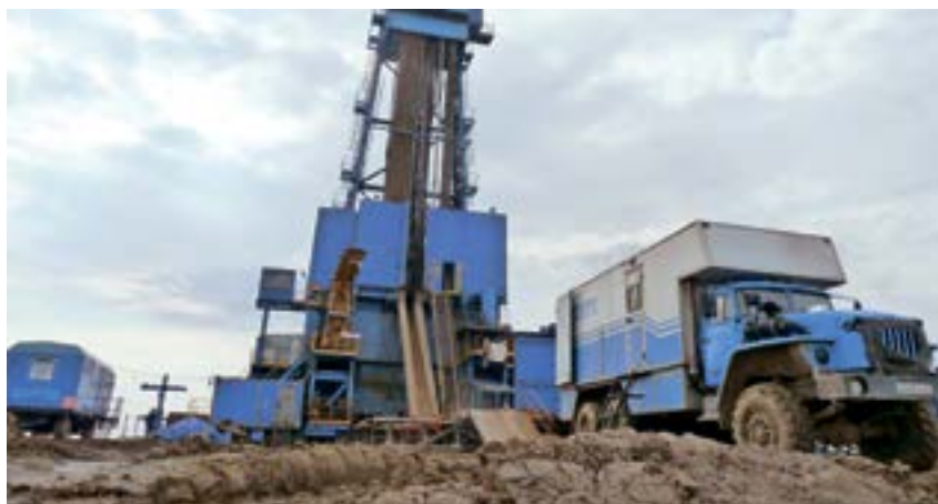
Рис. 5. Проведение каротажа на скважине
