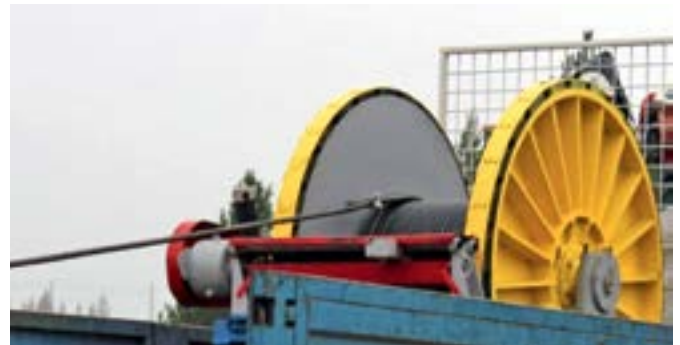
Рис. 11. Автолебедка с канатной штангой Fig. 11. Winch truck with rope rod
