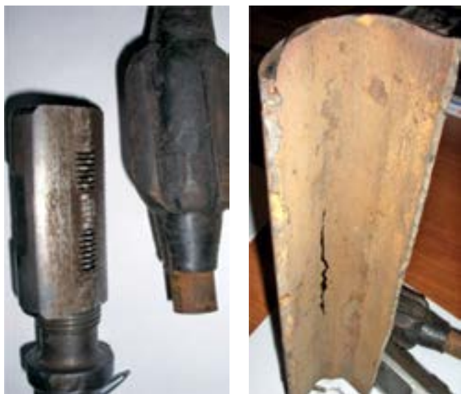
Рис. 5. Износ пары «штанга – колонна насосно-компрессорных труб» Fig. 5. Wear and tear of the sucker-rod/tubing string pair
