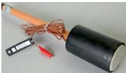
Рис. 3. СЭС-2ЭХЗ-Т – переносной вариант электрода сравнения Fig. 3. DEC-2EChemD – a portable version of the comparison electrode
