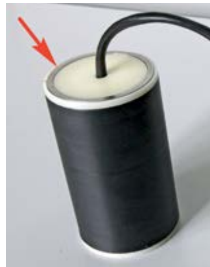
Рис. 1. СЭС-2ЭХЗ (стрелкой показан вспомогательный электрод)
