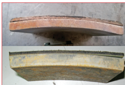
Рис. 2. Примеры неудовлетворительного результата теста термоциклирования
