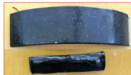
Рис. 4. Пример усадки полиэтилена при 150 °С: сверху – исходный образец; снизу – выдержанный при повышенной температуре
