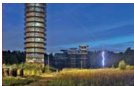
Рис. 2. Поле для испытания заземлителя анодного полимерного АЗП-РА на устойчивость к импульсным токам и перенапряжениям молниевго заряда (г. Истра)
