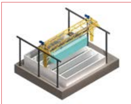
Рис. 4. Подъемные краны для ванн окунания
