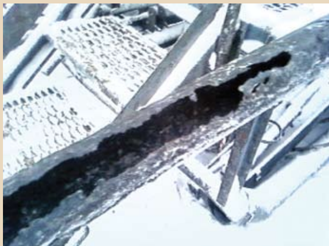
Рис. 1 - Коррозия НКТ под воздействием СКО
