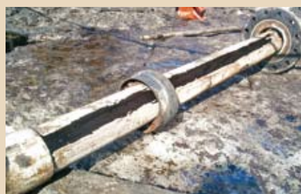
Рис. 3 – Коррозионные разрушения подземного оборудования скважин под воздействием ИСО
