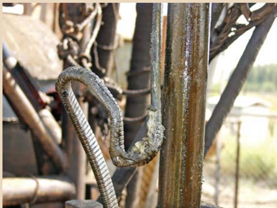
Рис. 3 – Коррозионные разрушения подземного оборудования скважин под воздействием ИСО
