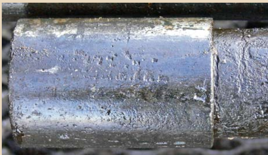
Рис. 5 - Питтинговая коррозия НКТ в результате воздействия ТЖГ
