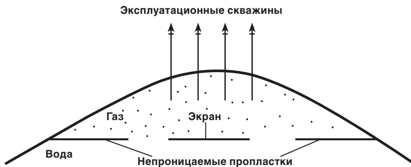
Рис. 3. Модель ПХГ с «литологическим окном». «Литологическое окно» расположено симметрично относительно зоны расположения скважин ПХГ и перекрывается экраном различного размера и проницаемости
