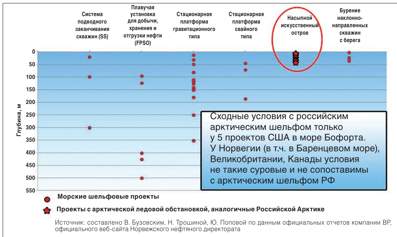
Рис. 4. Выбор технологии шельфовой добычи в зависимости от глубины моря
