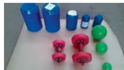
Рис. 2. Очистные устройства для трубопроводов с покрытием – манжетные, поролоновые «пули» и полиуретановые шары Fig. 2. Cleaning devices for coated pipelines – cuff, foam «bullets» and polyurethane balls
