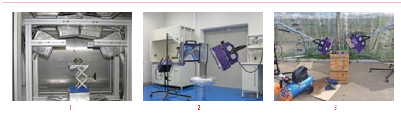
Рис. 2. УФ-отверждение AdvenGuard™ в камере (1), в помещении (2) и на улице (3)
