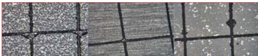
Рис. 1. Фотография результатов оценки адгезии покрытия методом решетчатых надрезов на отрыв (ASTM D3359/ГОСТ 15140-78): а – холоднокатаная сталь; б – алюминий-5052; в – оцинкованная сталь
