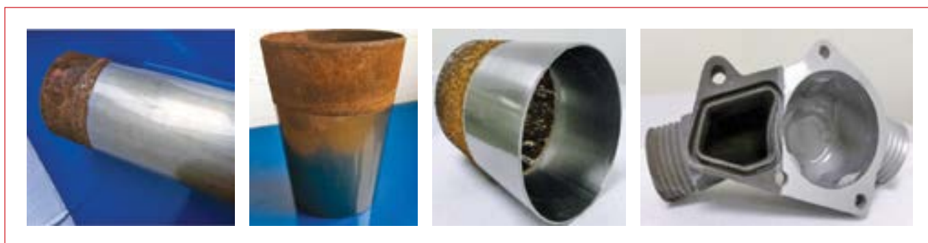
Рис. 3. Детали, обработанные антикоррозионным составом AdvenGuard™ в сравнении с необработанной поверхностью металла (Ст3, Ст20К)
