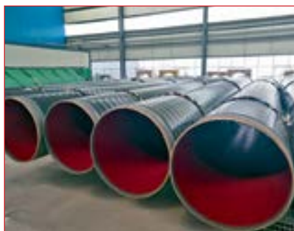
Рис. 1. Промышленное нанесение гладкого покрытия SN-109SF на трубы для проекта Sinopec
