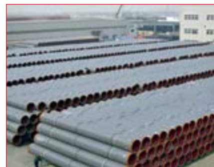
Рис. 2. Трубы с наружным порошковым покрытием для газопровода в Квинсленде (Австралия)
