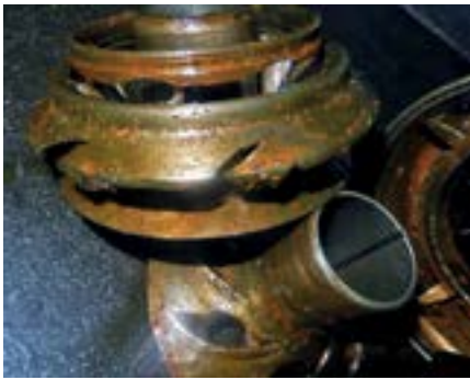
Рис. 3. Износ рабочих колес ступеней электроприводного лопастного насоса из нирезиста при наличии механических примесей
