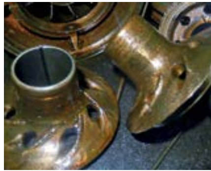
Рис. 3. Износ рабочих колес ступеней электроприводного лопастного насоса из нирезиста при наличии механических примесей
