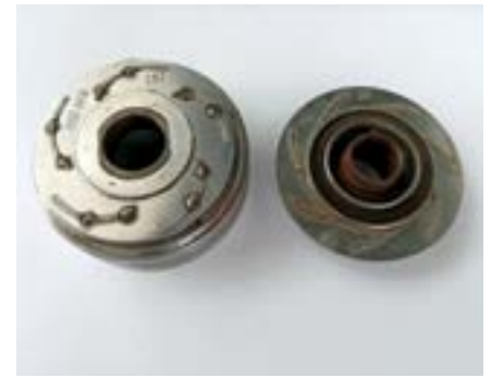
Рис. 4. Ступени, выполненные с помощью технологии «штамповка + сварка»
