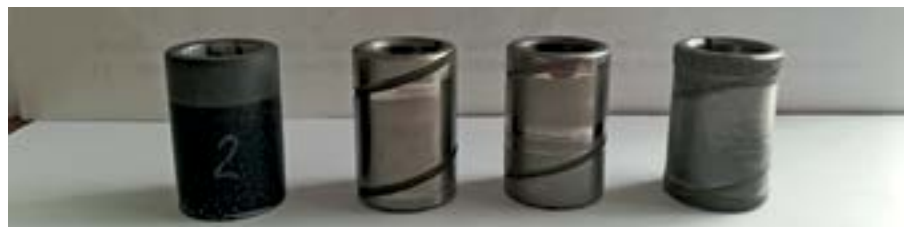
Рис. 8. Внешний вид защитных вращающихся втулок радиальных подшипников после испытаний на износ в модельной жидкости
