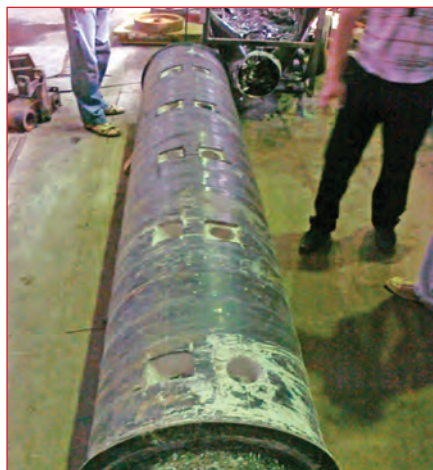
Рис. 4. Подготовленный к установке элементов контроля образец трубы
