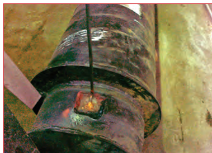
Рис. 2. Приваренный катодный вывод и изолированная торцевая поверхность образца трубы
