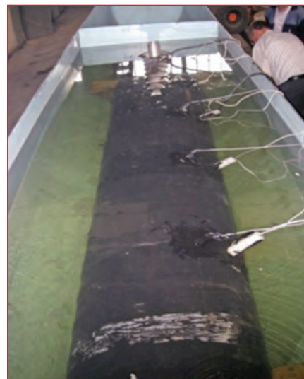
Рис. 6. Исследуемый образец трубы, помещенный в ванну с электролитом
