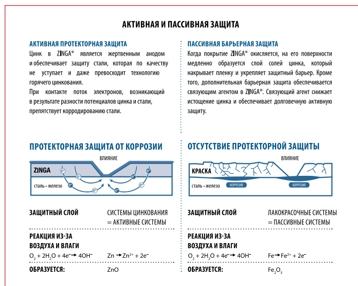
Рис. 1. Покрытие ZINGA®: активная и пассивная защита
